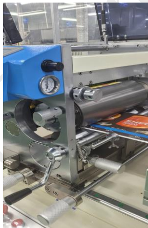
(Hình ảnh trục anilox trên máy in flexo)
